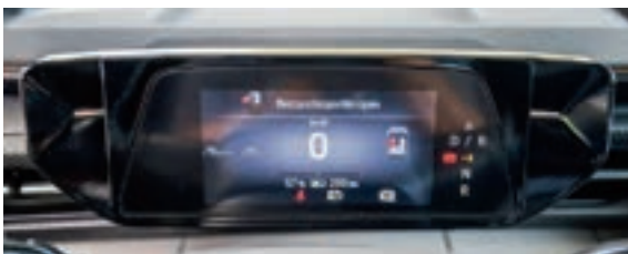
In tegenstelling tot de Volkswagen beweegt het instrumentarium in de Explorer niet met de stuurkolom mee.
